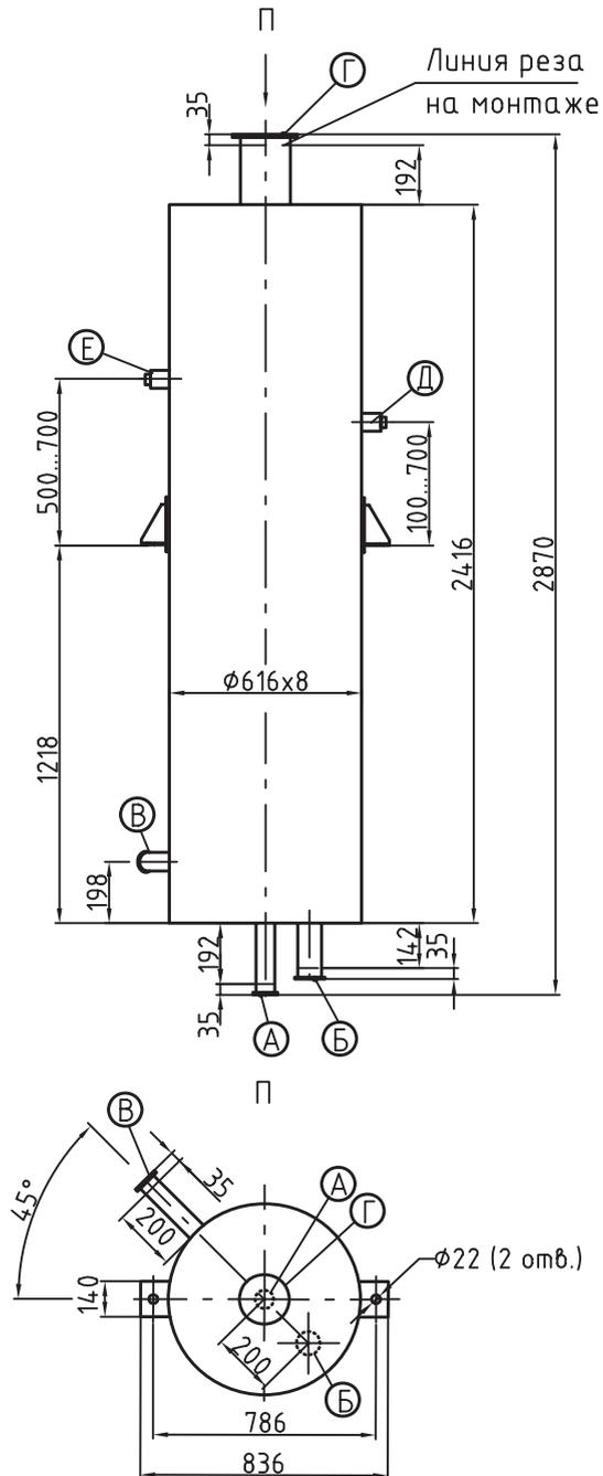
Деаэратор вакуумный. **ДВ-5**
